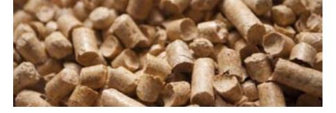
Technisch getrocknetes Holz kann auch übertrocknet sein. Es brennt dann zu schnell ab und kann vor allem in einfachen Anlagen ebenfalls erhöhte Emissionen verursachen. Aus diesem Grund sollte technisch getrocknetes Holz noch einige Zeit abgedeckt im Freien gelagert werden.
